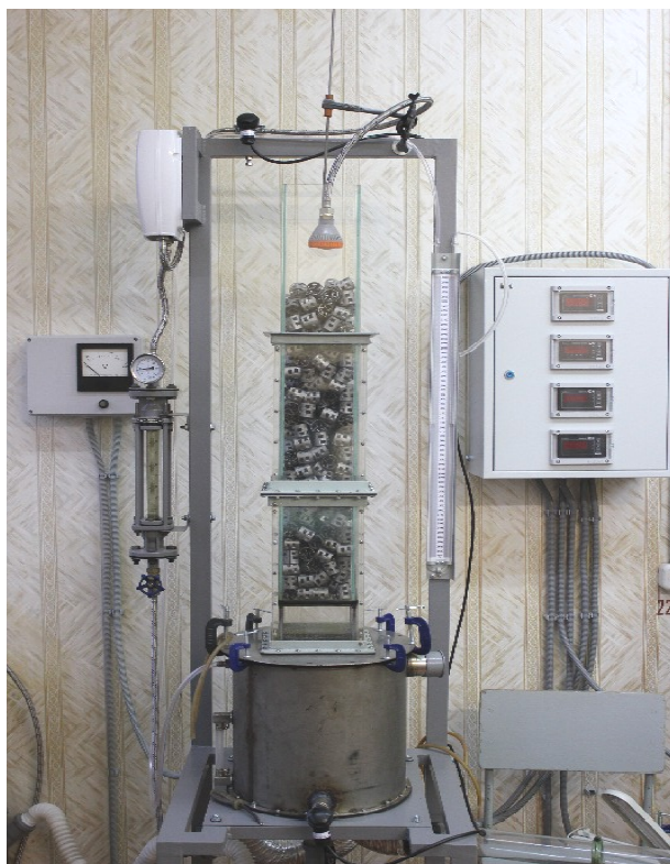
Рис. 1. Экспериментальная установка для исследования гидродинамики и тепломассообмена в насадочных устройствах
